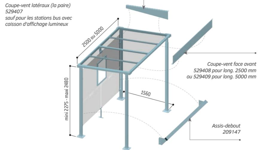
Attention : ne pas installer de banc ou d'assis-debout à proximité du caisson lumineux ou de la vitrine "2000" afin de ne pas en bloquer l'ouverture.
