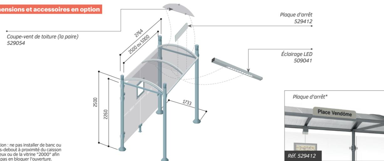
Attention : ne pas installer de banc ou d'assis-debout à proximité du caisson lumineux ou de la vitrine "2000" afin de ne pas en bloquer l'ouverture.
